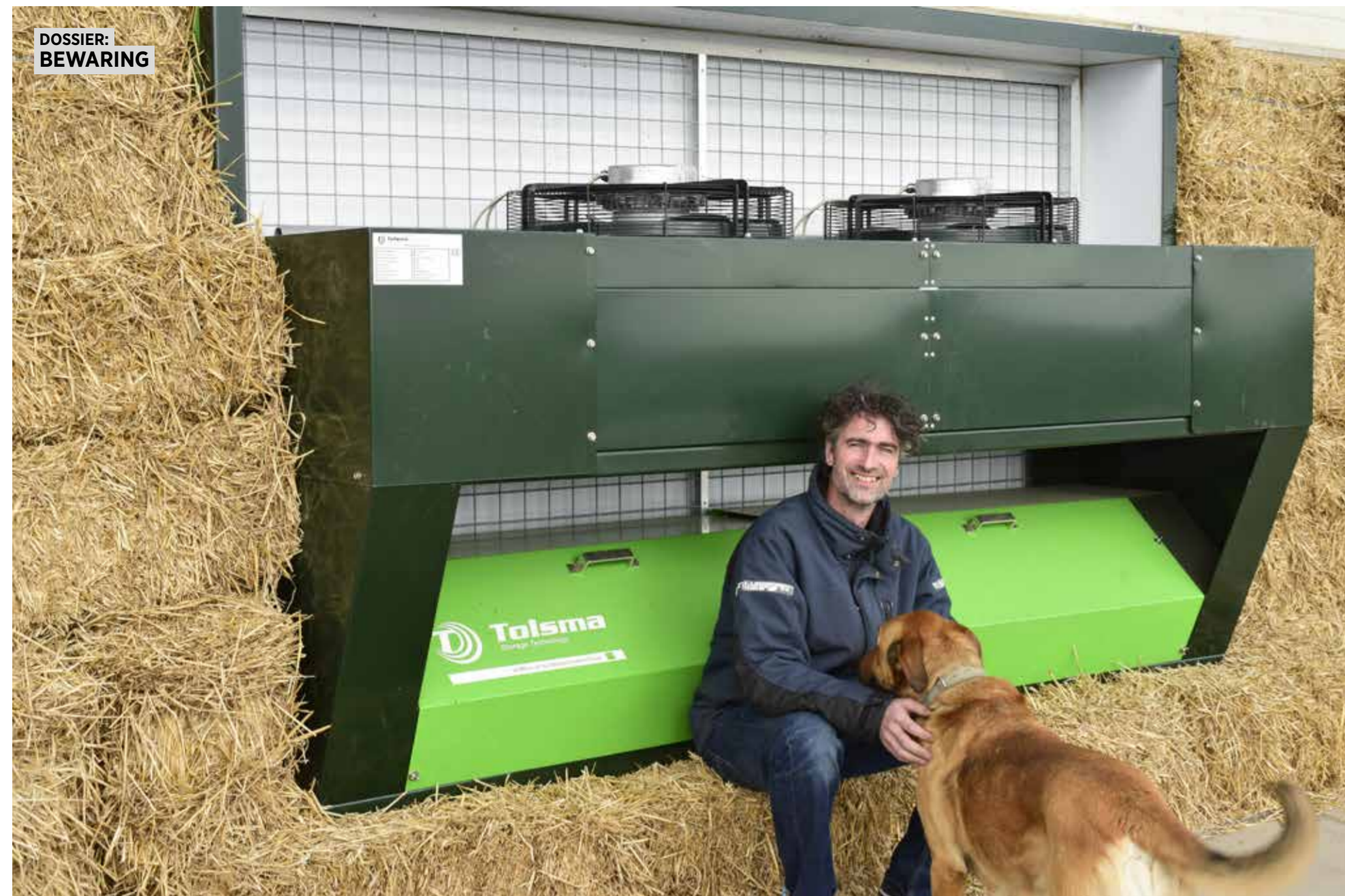
Philip Kroes gebruikt de mobiele koelinstallatie om het bewaarendement onder alle omstandigheden optimaal te houden.
